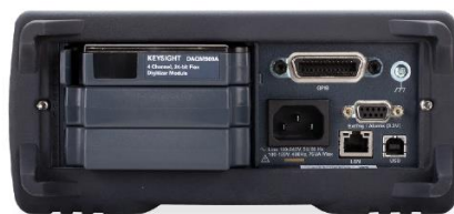
裏面図：DAQ973Aメインフレーム (USB/LAN/GPIBインタフェース装備)
